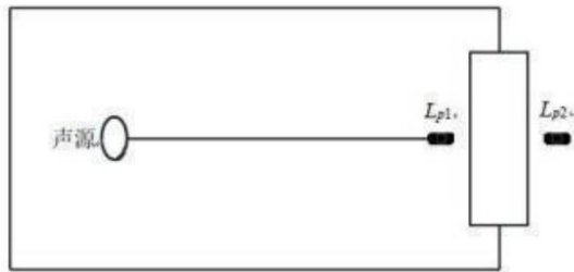
图 4-1 室内声源等效为室外声源图例
