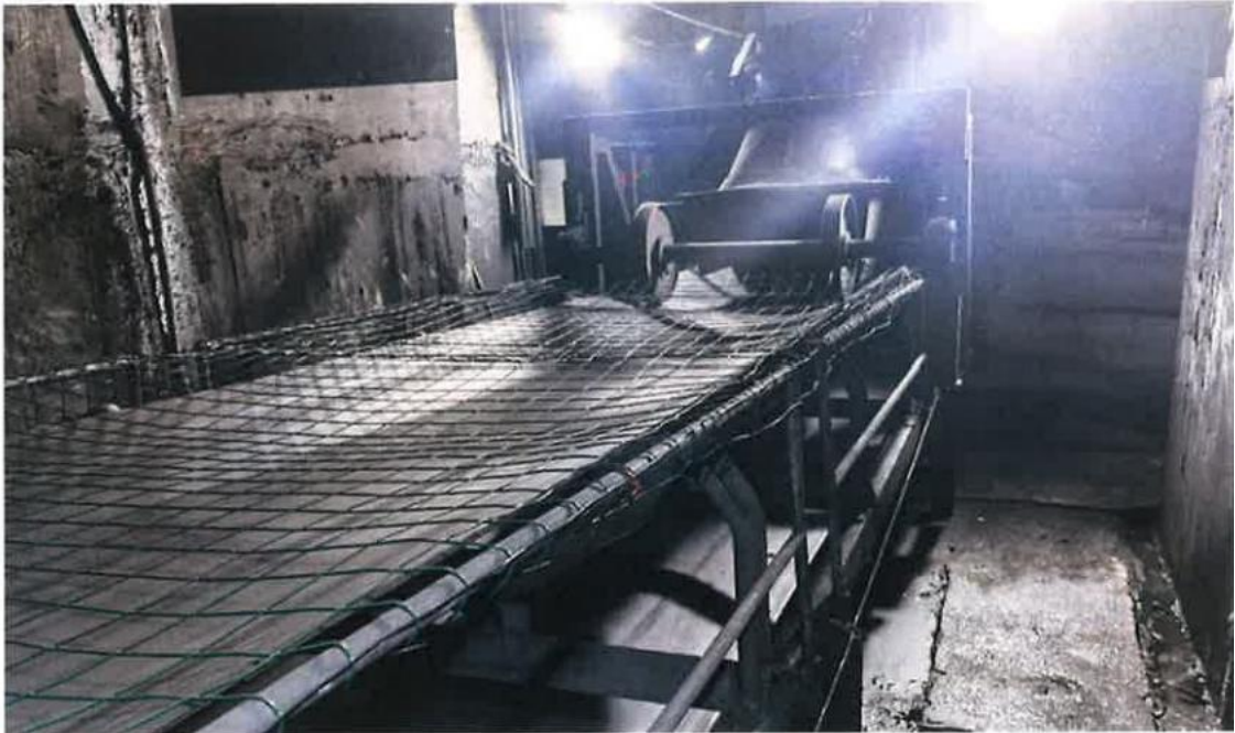
图1 X1皮带机尾部位(邓盛强登上皮带点，防护网为事后加装)
