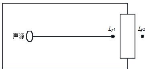
图 4.2.1 室内声源等效为室外声源图例
